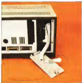
In questo piccolo stampato sono ripresi il cavo di alimentazione e quello della tastiera
